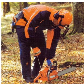
Rys.1 Dopuszczalne sposoby uruchamiania pilarki
