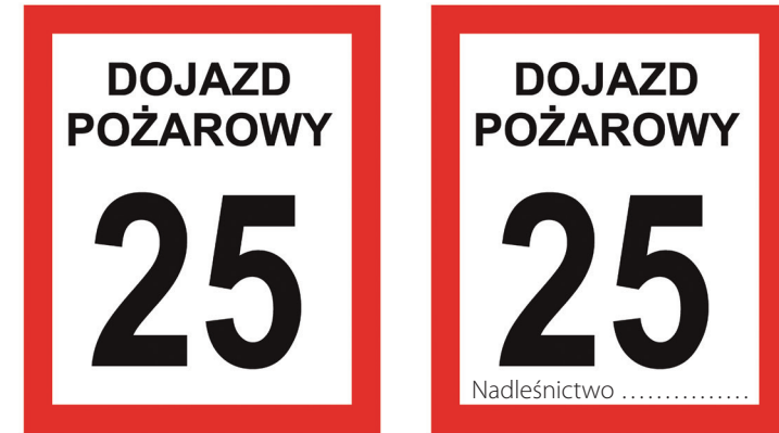
Rycina 2. Oznakowanie dojazdu pożarowego tablicą
